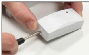
Hebeln Sie die verbrauchte Knopfzelle mit beiliegendem Schraubendreher aus ihrem Halter. Fahren Sie von oben mit dem Schlitz-Schraubendreher zwischen Kontakt und Knopfzelle und bewegen den Griff nach außen, die Knopfzelle springt aus ihrem Halter.
